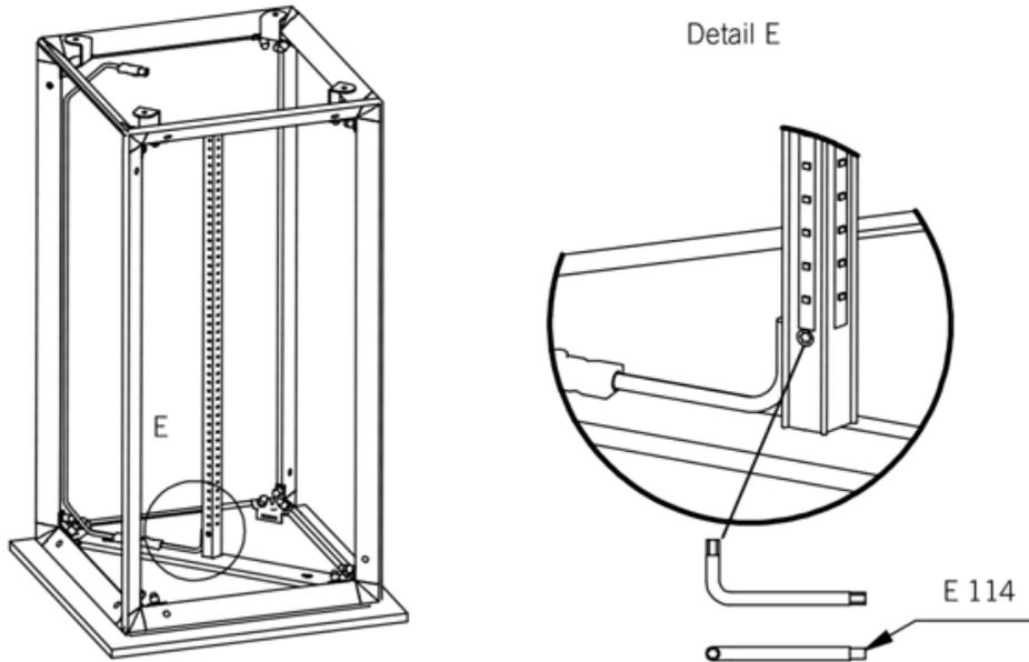
6. Klebesockel OL 254 an Profil vertikal fixieren, Verbindungsleitung OL 139 mit Kabelbinder OL 255 befestigen
